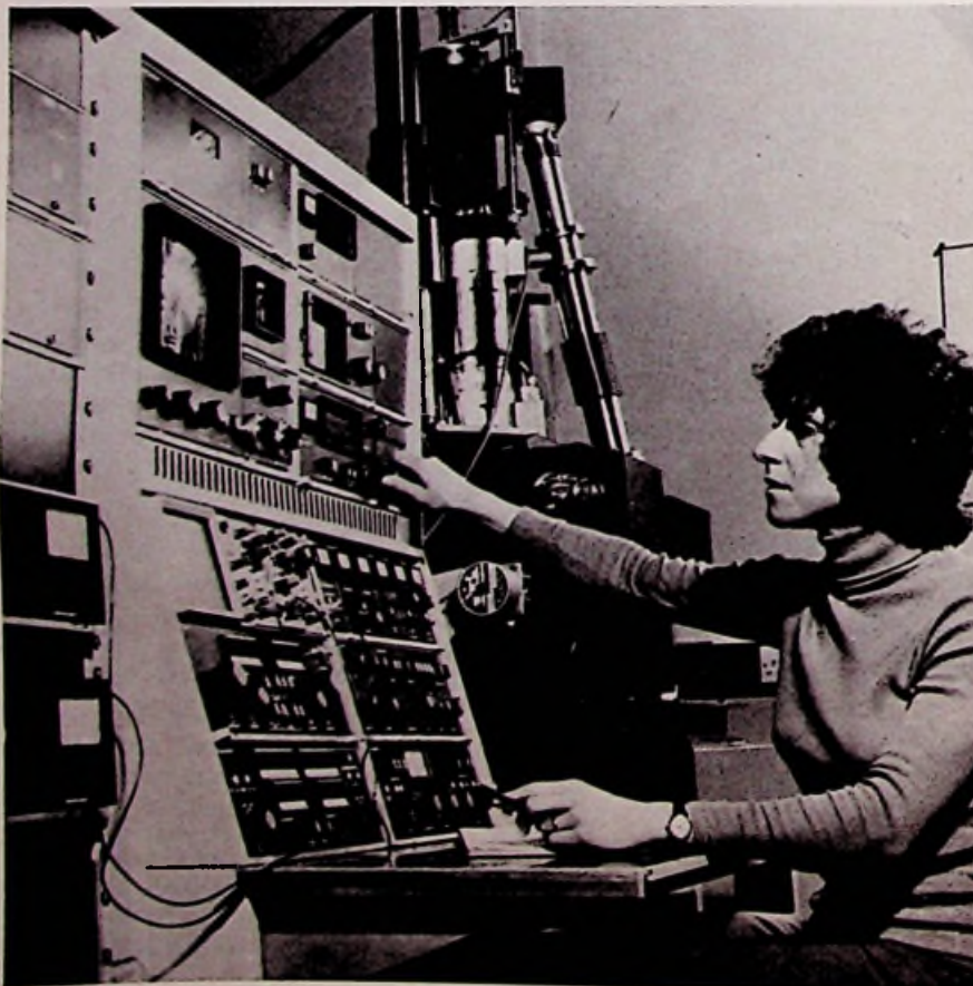
Bild 2. Erprobung der im Philips Forschungslaboratorium in England gebauten Anlage zum Herstellen von integrierten Schaltungen mit Hilfe eines Elektronenstrahls.
